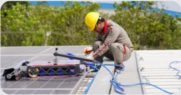
ĐỐI VỚI MÁI ĐẶC THÙ Sử dụng robot, hiện đại với tốc độ 3s/pin: Hiện đại, chuyên nghiệp và phù hợp với thiết kế tấm pin
